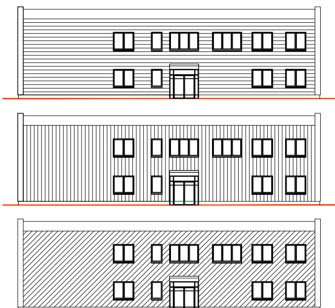
Układ paneli: pionowy, poziomy lub skośny. Panel layout: vertical, horizontal, slanted.
